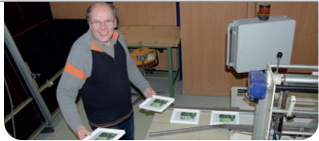
Die Bilderrahmen werden per Hand in den Einschweiß-tunnel gelegt
